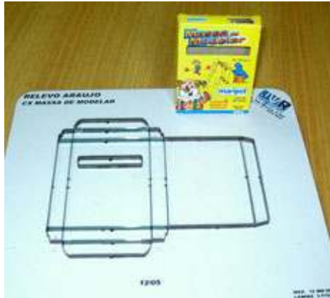
Corte e Vinco Marca Guangya formato 52x75 com Hot Stamping
