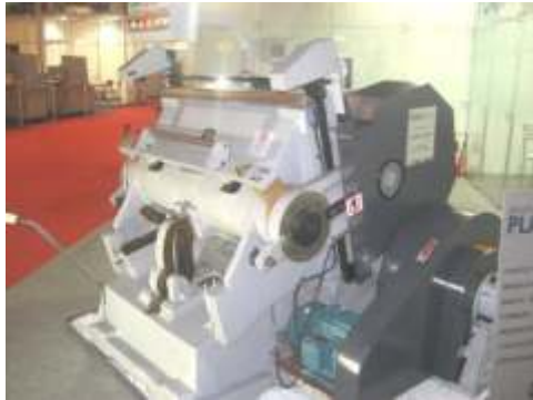
Corte e Vinco Marca Guangya formato 52x75 com Hot Stamping
